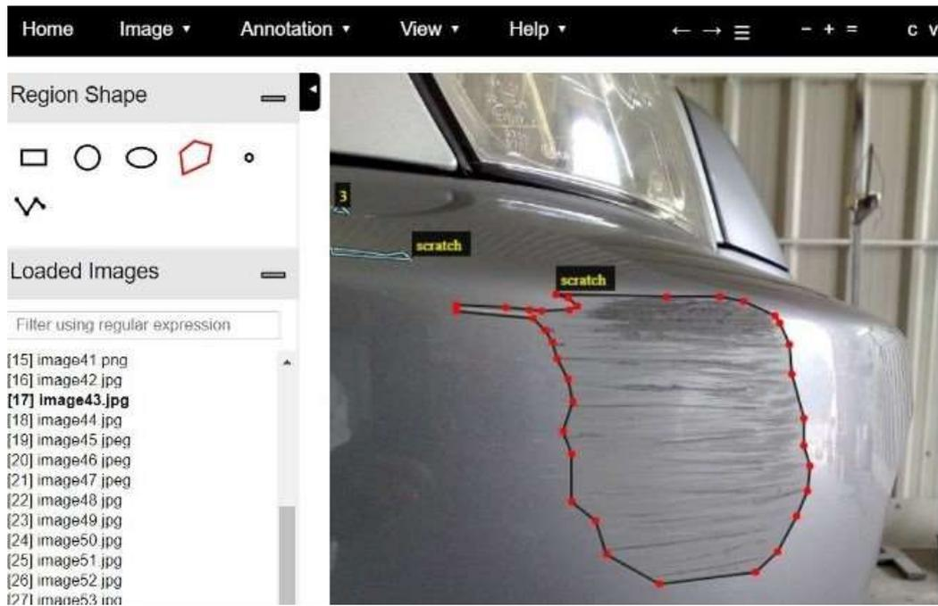
**Fig. 4. Scratch detection**
